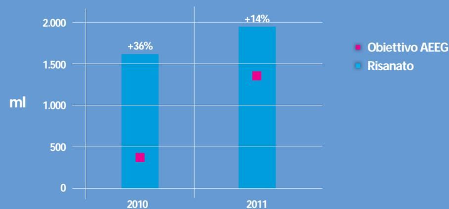
**SOSTITUZIONI DELLE TUBAZIONI IN GHISA GRIGIA CON GIUNTI CANAPA PIOMBO CON ALTRO MATERIALE (POLIETILENE/ACCIAIO) DELIBERA AEEG NR. 120/08**
